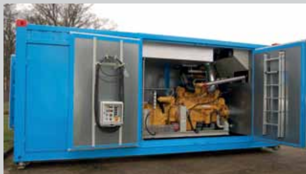
Насосная установка в контейнерном исполнении, двигатель 600 л.с.
