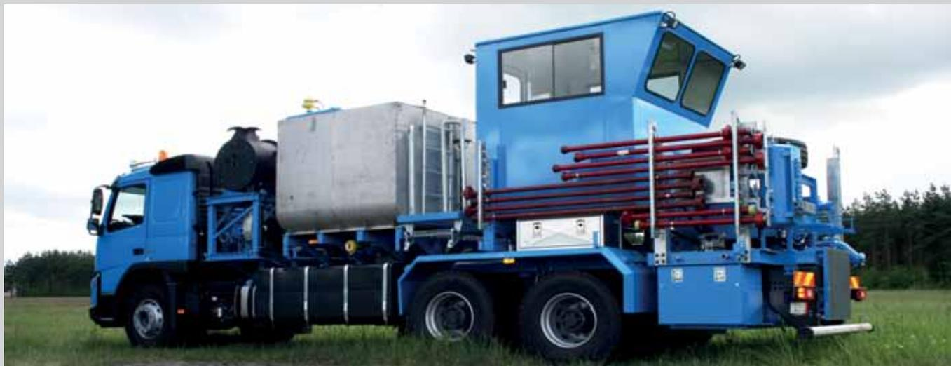
Многофункциональная насосная установка на шасси
