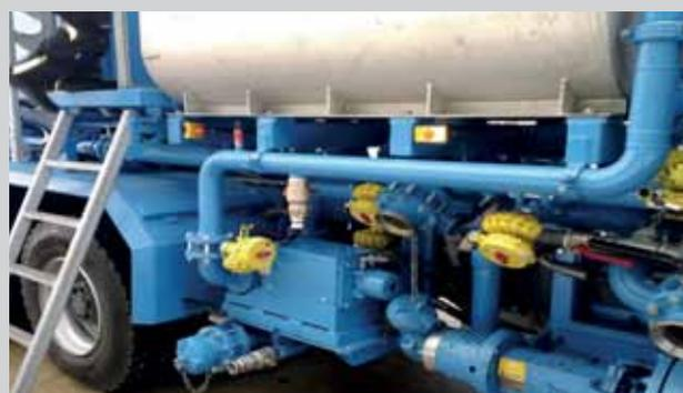
Трубопроводная обвязка и мерная ёмкость из нержавеющей стали
