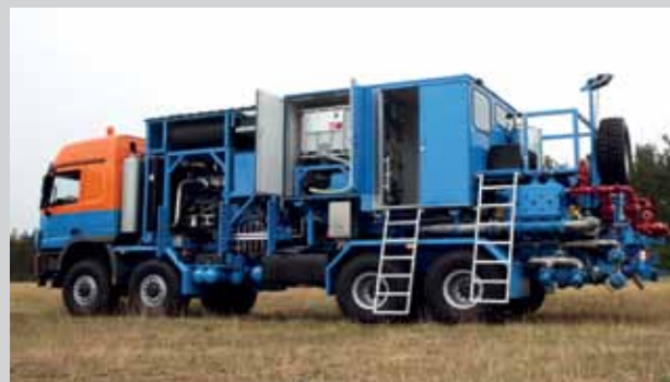
Двухнасосный агрегат с системой подачи химреагентов
