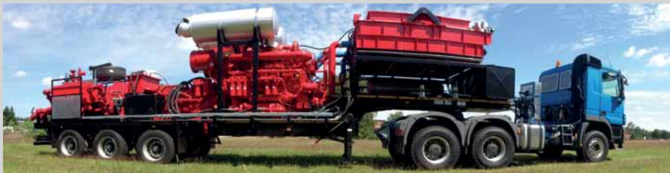
Насосная установка на полуприцепе 2500 л.с.
