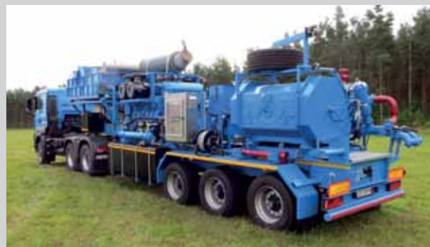
Насосная установка на полуприцепе 2250 л.с.
